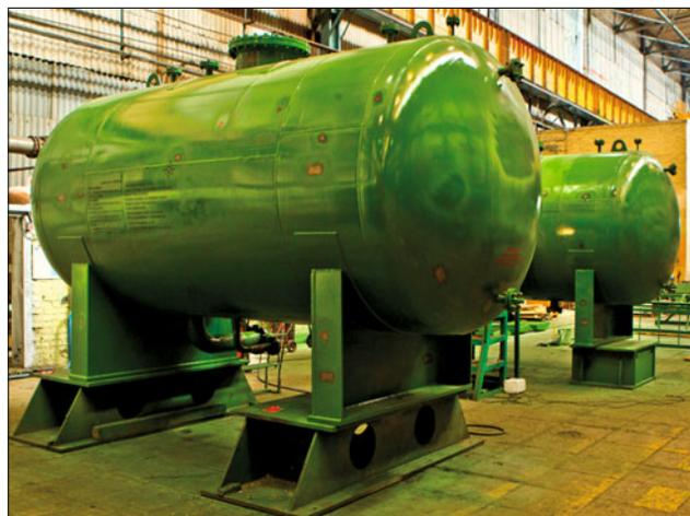
Впоследствии бак оборудуют двумя независимыми датчиками уровня, сигнализирующими на блочный и резервный пункты управления об уровне топлива. Назначенный срок службы – 60 лет. Технический проект и конструкторская документация разработаны специалистами ПАО “ЗиО-Подольск”.
