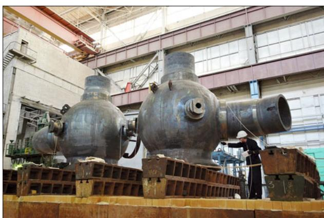
Корпуса ГЦН – изделия первого класса безопасности. На атомной станции главный циркуляционный насосный агрегат
