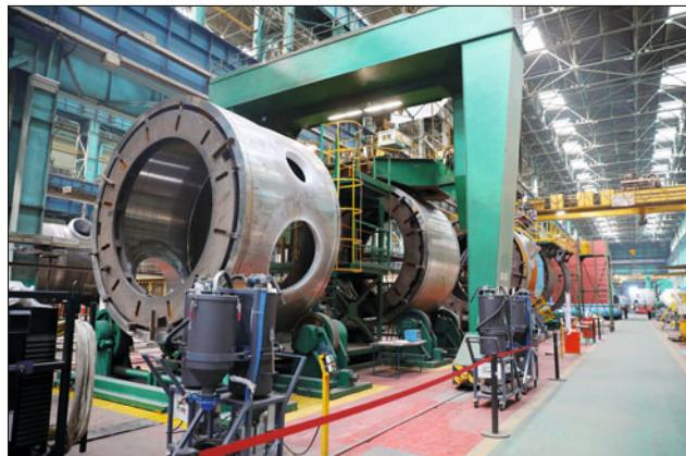
Для атомной станции в Индии “Атоммаш” изготовлен и отгрузил два комплекта парогенераторов для третьего и четвертого блоков АЭС Куданкулам.
