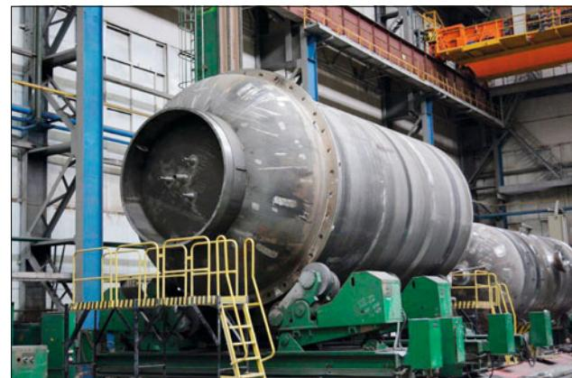
Система пассивного залива активной зоны является важнейшим элементом системы безопасности АЭС и предназначена для отвода остаточных тепловыделений теплоносителя первого контура реактора. На один энергоблок приходится восемь емкостей СПАЗ. Каждая представляет собой толстостенный сосуд из нержавеющей стали объёмом 120 м<sup>3</sup>. Масса
