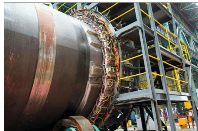
При местной термообработке зоны сварных швов закрывают керамическими ковриками – термопарами. Затем нагревательные элементы плавно доводят до 620 – 660°C. Специалисты регулируют температуру на 12 зонах сварного шва. Фиксация температуры ведётся каждые полчаса. Разбежка по термопарам не должна превышать 40°C. Местная термическая обработка включает в себя не только постепенный нагрев шва, но и плавное остывание соединения. Полностью процесс занимает полтора – два дня.
