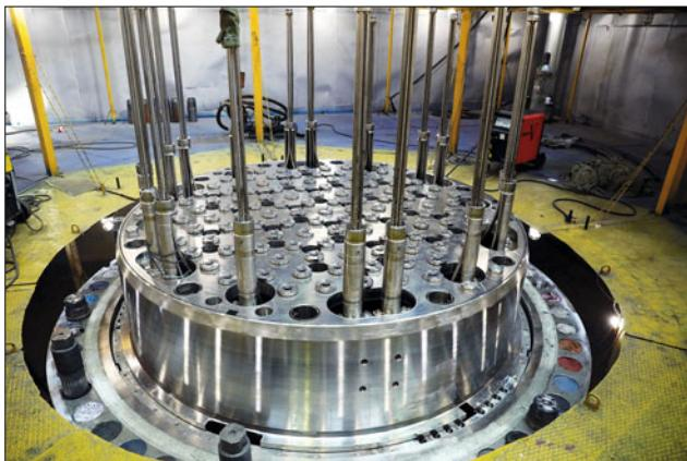
Реактор представляет собой вертикальный цилиндрический корпус с эллиптическим днищем, внутри которого размещается активная зона и внутренкорпусные устройства. Сверху реактор герметично закрыт крышкой с установленными на ней приводами механизмов и органов регулирования и защиты реакторов и патрубками для вывода кабелей датчиков внутриреакторного контроля.
