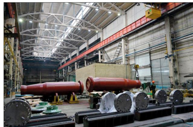
В процессе изготовления кованая заготовка проходит механическую обработку, на внутреннюю поверхность наносится антакоррозионная наплавка, проводится сварка деталей корпуса и их термообработка. При сварке и наплавке одного коллектора расходуется свыше 2 т сварочных материалов. Масса полностью изготовленного коллектора превышает 16 т. На каждой стадии изготовления изделия контролируется его
